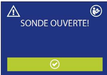
Attention, fuite au niveau de la sonde. Vérifiez la sonde
