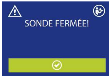
Attention, sonde obstruée. Vérifiez la sonde.
